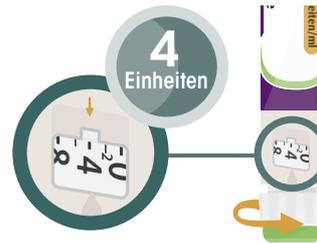
Stellen Sie 4 Einheiten ein, indem Sie den Dosierring drehen, bis der Dosisanzeiger auf der „4“ steht.
