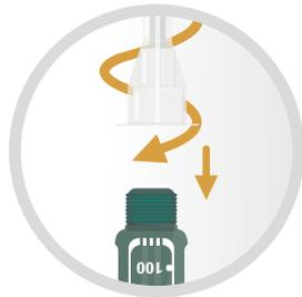
Halten Sie die Nadel gerade und schrauben Sie sie auf den Pen, sodass sie fest sitzt. Überdrehen Sie dabei nicht das Gewinde.
